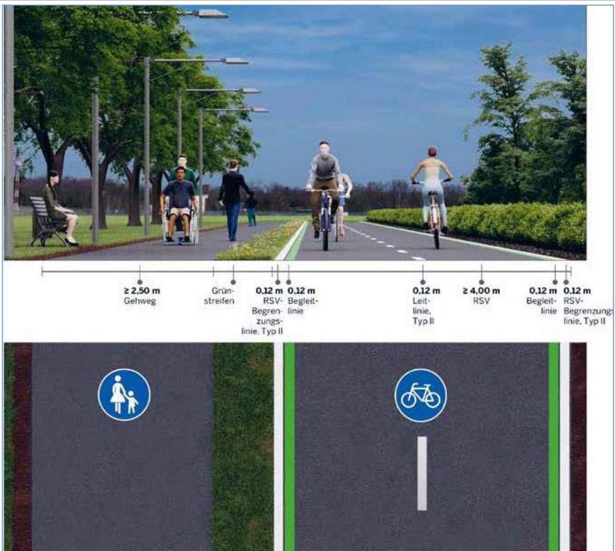
Abbildung 7<sup>11</sup>: RSV als eigenständig geführter Zweirichtungsweg mit baulicher Trennung
