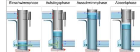
So funktioniert der Fischlift am Werdener Wehr. Foto: Ruhrverband
